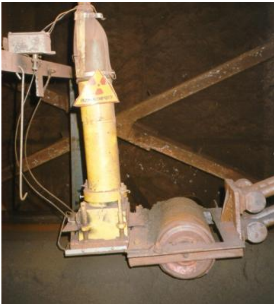
Рис. 2.6. Периферійний вузол вимірювання системи НАКС-ПК
